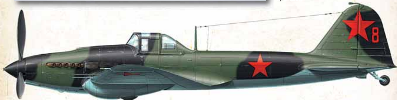
Ил-2 ранних производственных серий с металлически крылом и фюзеляжем. На крыле присутствуют весовые компенсаторы. Вооружен пушками ШВАК.
